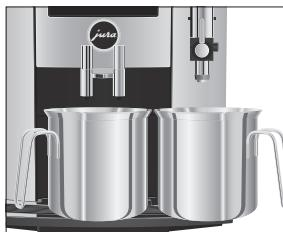
При выключении кофемашины S8 промывка системы выполняется автоматически, если была использована функция приготовления кофейного напитка. Если была использована функция приготовления молока, кофемашина дополнительно выдает запрос на очистку системы приготовления молока.
